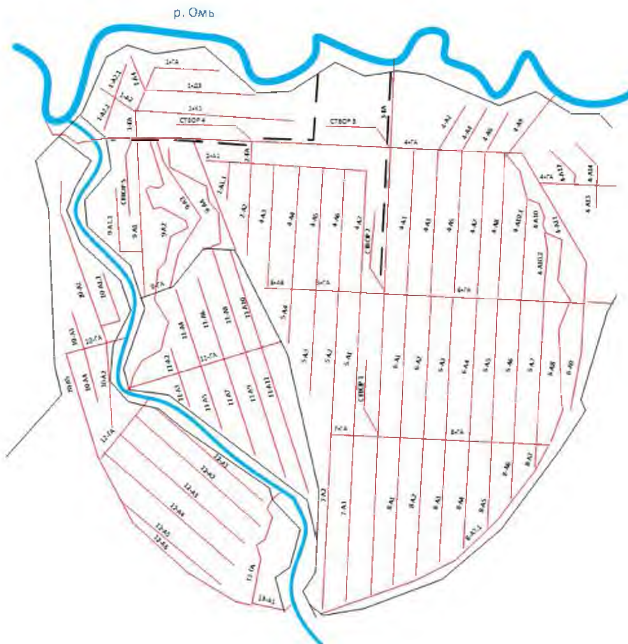
Рисунок 2.103 – Схема системы лиманного орошения «Пушиха»
