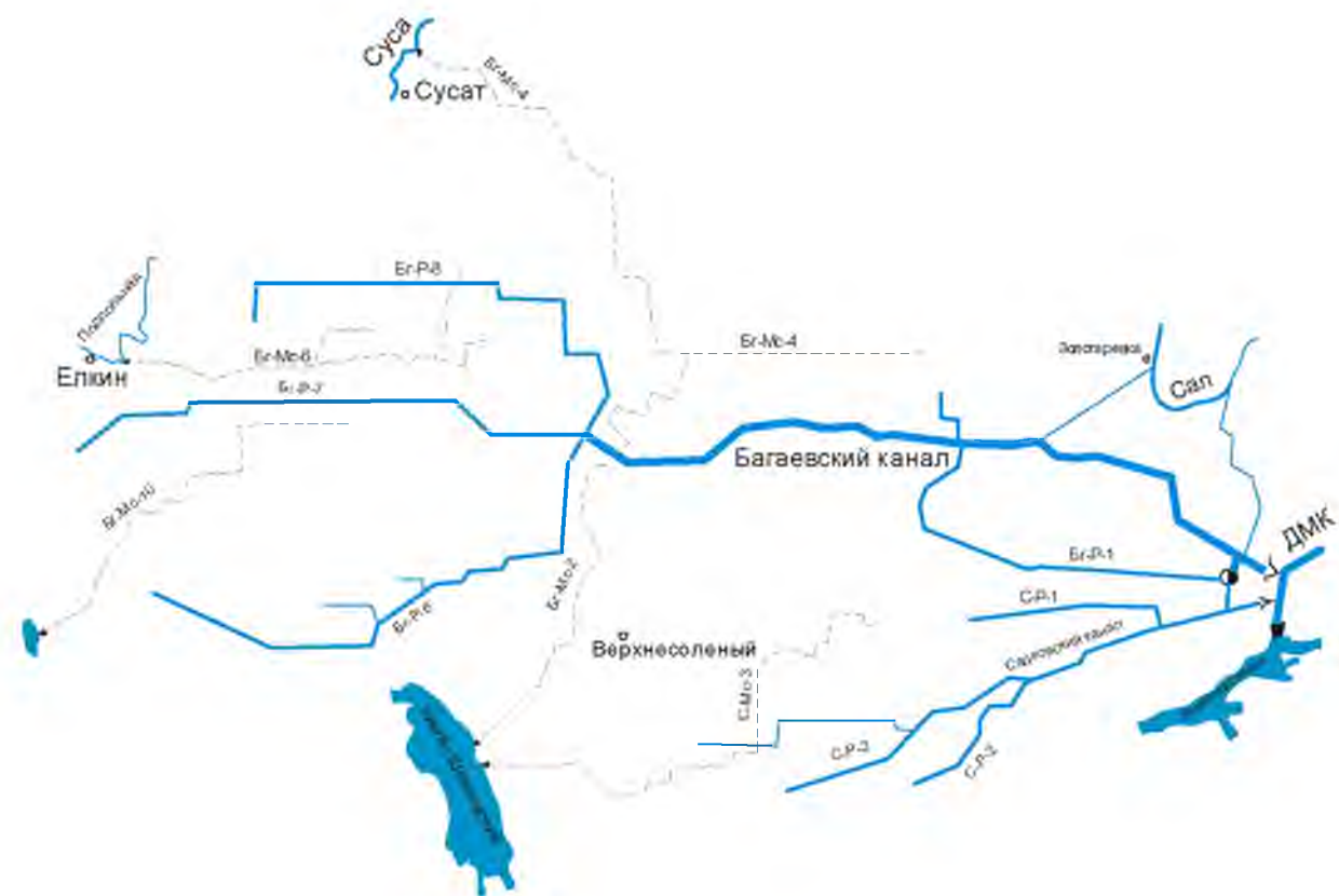
Рисунок 2.41 – Схема Багаево-Садковской оросительной системы
