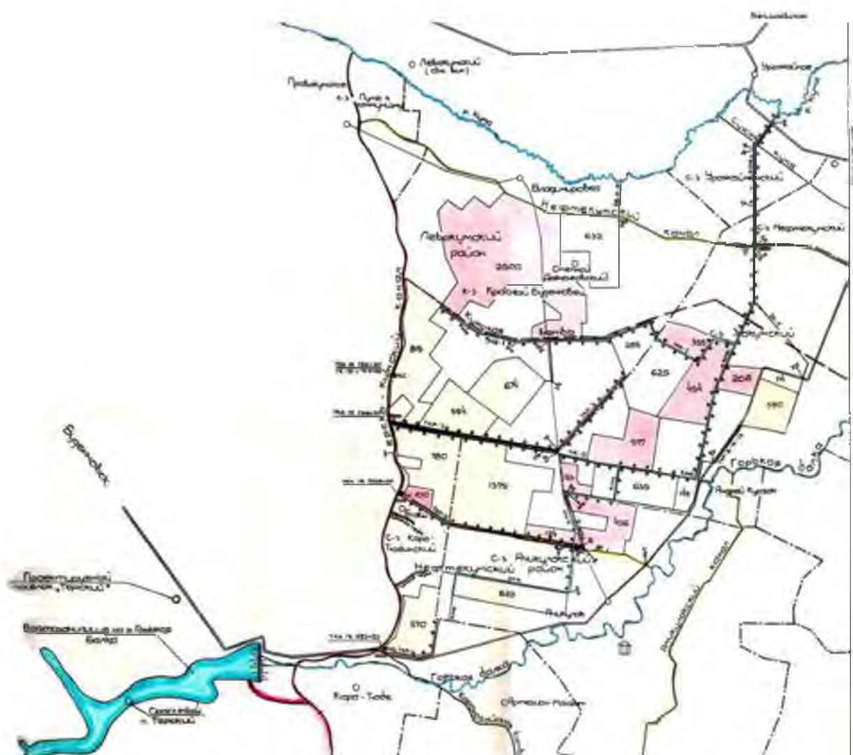
Рисунок 2.68 – Схема Кумской оросительной системы
