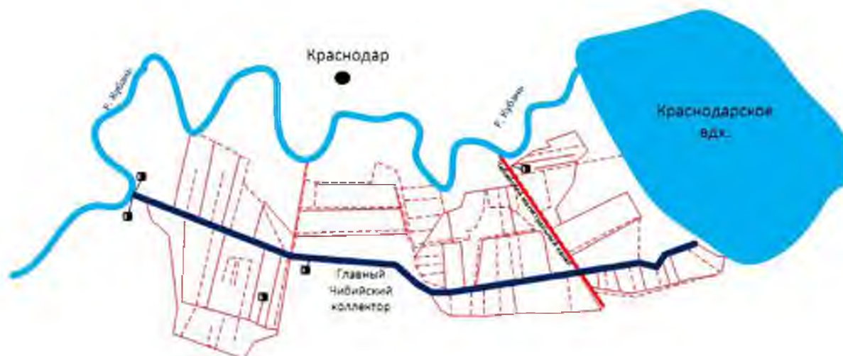
Рисунок 2.3 – Схема Чибийской оросительно-осушительной системы
