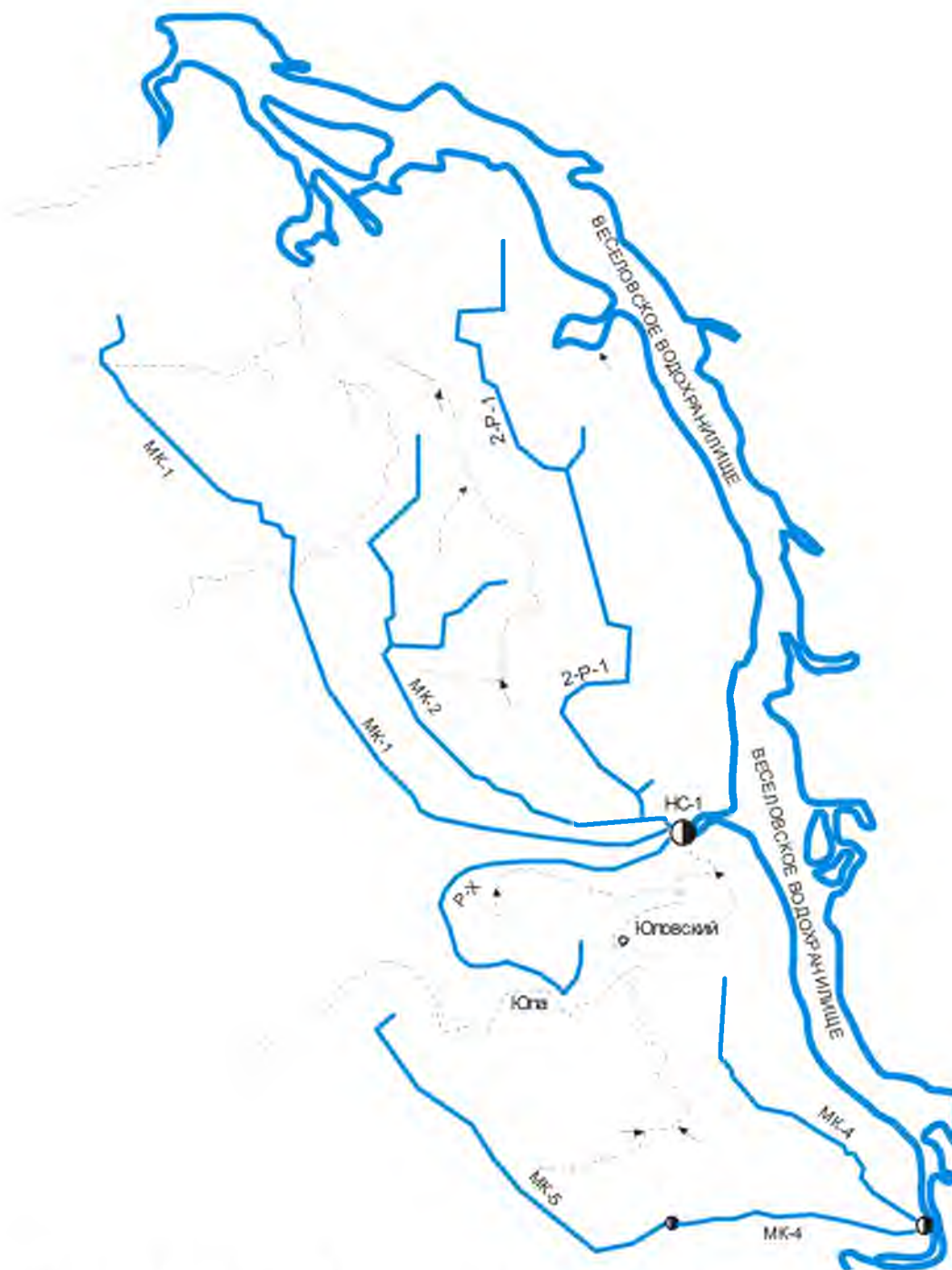
Рисунок 2.46 – Схема Манычской оросительной рисовой системы
