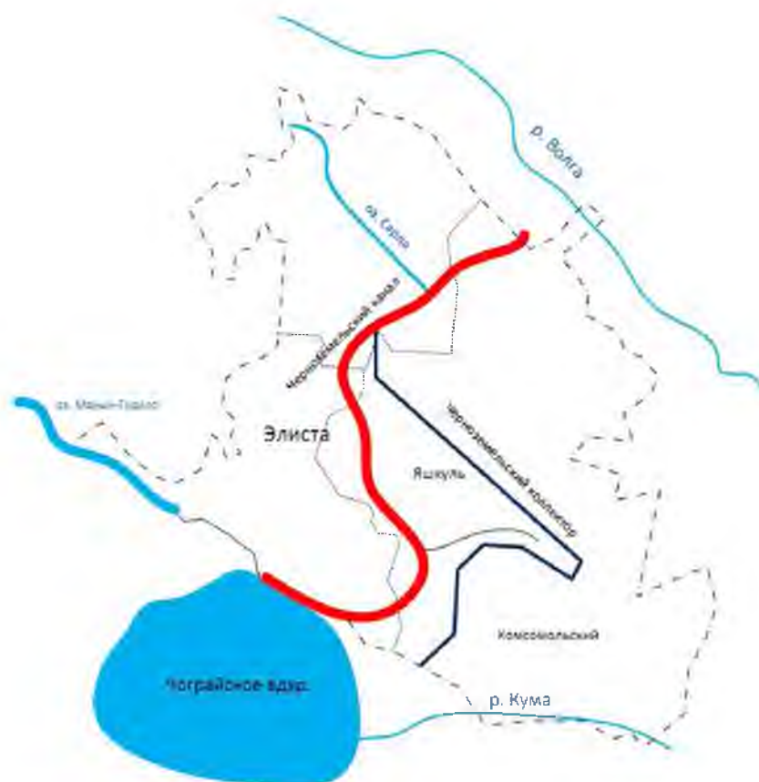
Рисунок 2.6 – Схема Черноземельской оросительно-обводнительной системы
